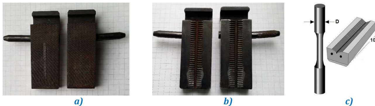
Rys. 13. Szczęki zaciskane na klinie: a) do próbek płaskich, b) do próbek walcowych, c) relacja średnica A części chwytowej a kształt przyrzątkowego wybrania
